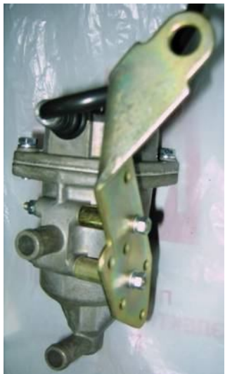
Рисунок 1. Крепление кронштейна к подогревателю.
