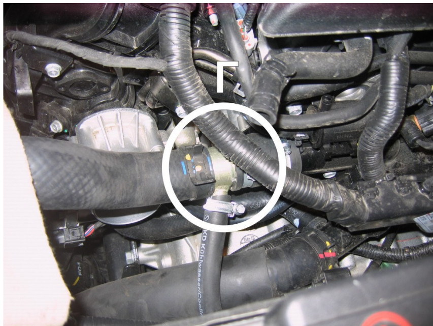
Рисунок 4. Врезка тройника выходного рукава. Вид сверху слева.
